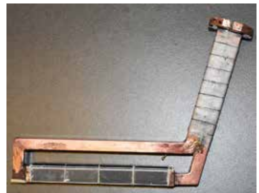
Bild 7: Die „Primärwicklung“ ist auf eine einzige Winding zusammengeschrumpft!
