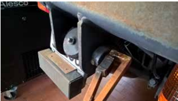
Bild 12: Bolzen und Schrauben durch schnelle Erwärmung im Rost freidrücken
