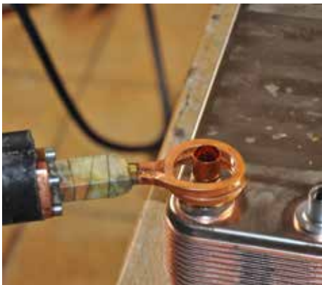
Bild 3: Innenfelderwärmung beim Hartlöten Chromnickel-Kupfer an Wärmetauscher
