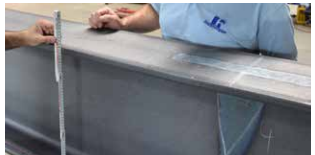
Bild 9: Thermischer Richtmechanismus auf Basis der verhinderten Ausdehnung
